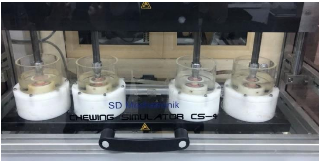
Şekil 2: Deneyde kullanılan dual akslı çiğneme simülatörü
