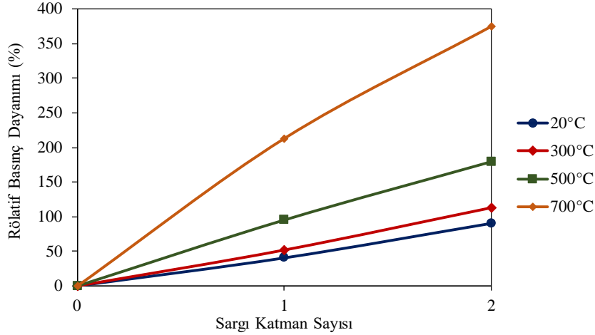
Şekil 7. Sargı katman sayısının rölatif basınç dayanımı üzerine etkisi
