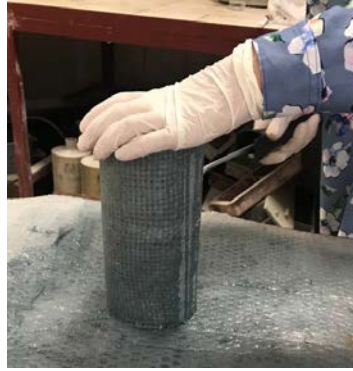
Şekil 1. GFRP ile silindir numune güçlendirmesi
