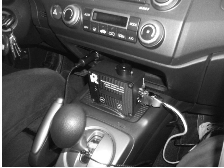
Şekil 3. Elektronik ball-bank cihazının araçtaki konumu
