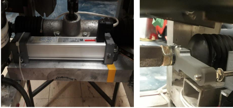
Şekil 2. Lineer potansiyometrenin araca entegrasyonu
