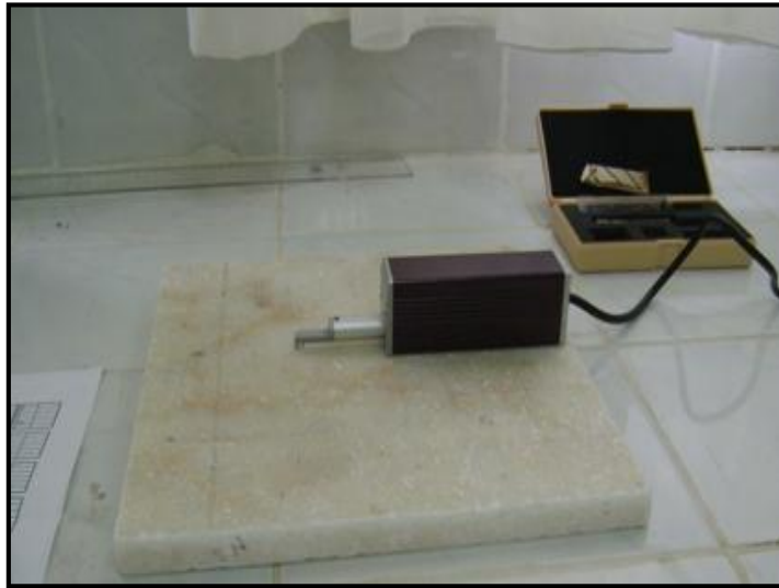
Şekil 3. Yüzey pürüzlülük test cihazı (Mitutoyo SJ – 400)
