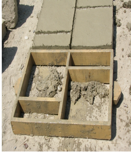
Foto. 6: Kerpi Kalıp Görünüőü.
