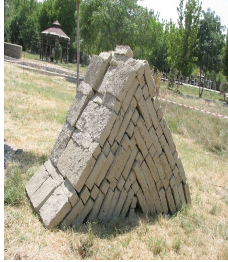
Foto.10: Kerpiç İstifleme Görünüşü.
