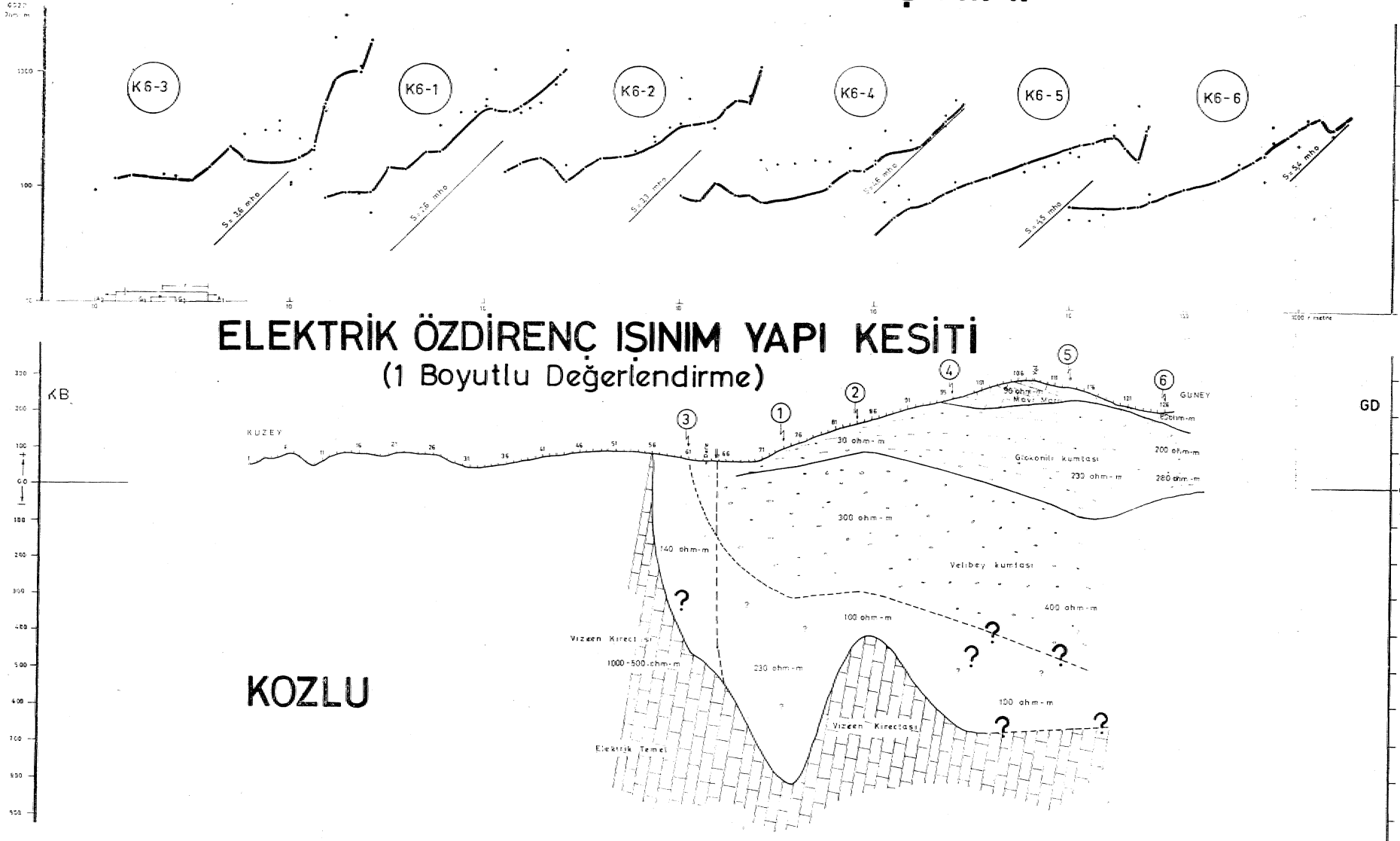
Şekil 14 : Kozlu - Zonguldak taşkömürü bölgesinde, jeolojik birimlerin DB doğrultulu uzanımına dik geçecek KG doğrultusunda 1, 2, 3 ve 4 noktalarında yapılan yapay doğru akım Schlumberger açma ölçümlerinden çıkarılan yer elektrik yapı kesiti. Açma eğiliminin değerlendirilmesinde bir boyutlu (IB) yatay katmanlı süreksizlik (EBERT) taslak eğrilerinden yararlanılacak süreksizliklerin düşey yönde geçişleri saptanmış ve belirgin süreksizlik geçişleri birbirleri ile birleştirilmiştir. Bölmelerin adlandırılmasında jeolojik verilerden yararlanılmıştır.
