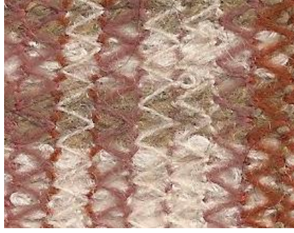
Fotoğraf 12 Atkı ve çözgü ipliklerinin renk raporlu kullanımıyla üretilmiş ekose kumaş örneği. (Kaynak: Kettenwirk Praxis –Karl Mayer, Max Dorn Presse, Germany – 4/1994,S.91).
