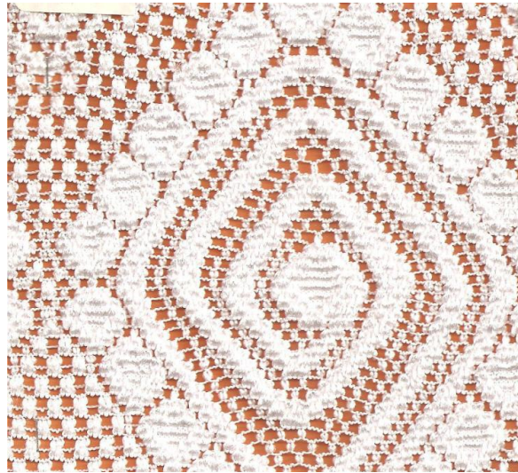
Fotoğraf 5 Jakarlı raşel örme makinesinde, ince ve kalın iki iplikle oluşturulan hacimli desen. (Kaynak: 28235-1 kodlu perdelik kumaş örneği, Aydın Örmecilik San.Tic.A.Ş. İstanbul, 2009).
