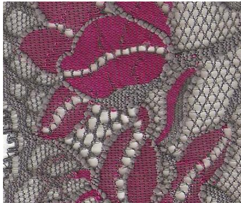
Fotoğraf 10 Desen kılavuzlarında farklı renkte iplik kullanılmasıyla üretilmiş kumaş örneği. (Kaynak: Karl Mayer Design Sample, Des. JL65B 005, Germany, 2004).
