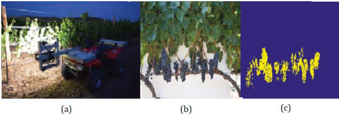
Şekil 11. (a) Hareket halindeyken görüntü yakalama sistemi: otomatik kamera tetikleme, LED aydınlatma ve kolay konum ayarı için yapı, (b) Kontrolsüz aydınlatma koşullarında çekilmiş bir asma görüntüsü, (c) RGB ve HSV temsillerini kullanarak yapılan segmentasyon sonucu (Millan vd., 2018).
