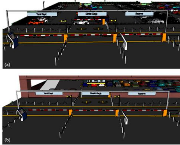
Şekil 7. (a) Açık ve (b) kapalı otoparklar için önerilen iki kademeli otopark giriş sistemi
