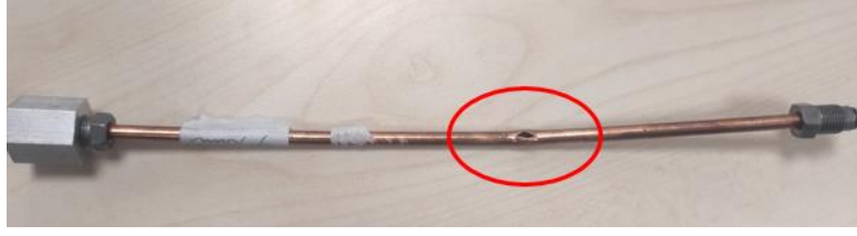
Şekil 3. Patlatma testi sonrası parçanın örnek görüntüsü
