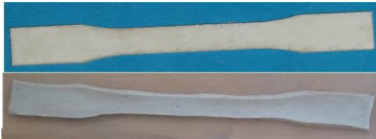
Şekil 3. Standart ve büzüşmüş test numuneleri
