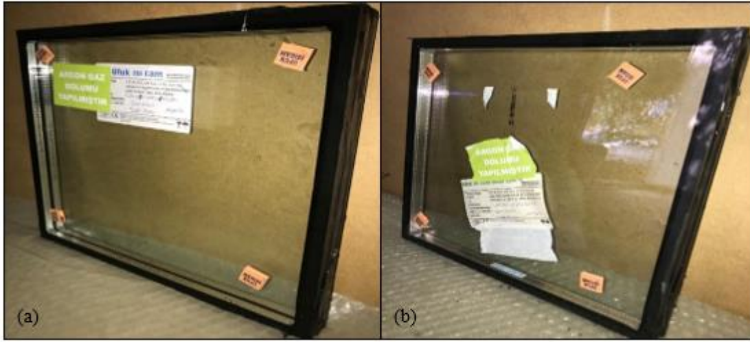
Şekil 2. Üç ve iki katmanlı argon gazlı camlar (a) Üç katmanlı cam örneği (b) İki katmanlı cam örneği Figure 2. Three- and two-layer argon gas glasses (a) Example of three-layer glass (b) Example of two-layer glass
