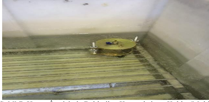
Şekil 7. Havuz içerisinde Bekletilen Kompaksiyon Kalıbı (Mold).
