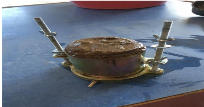
Şekil 10. ZETES1 Termik Santrali Uçucu Külü Tek Başına Kullanımı Düşen Seviyeli Permeabilite Deneyi Sonucu.
