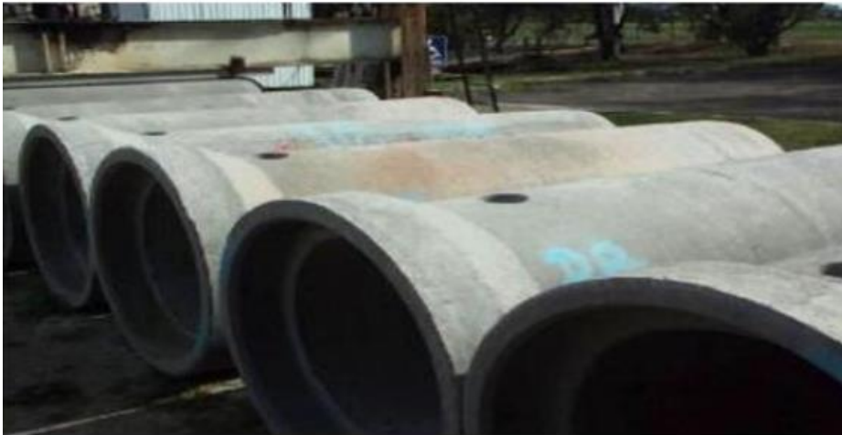
Şekil 6. Geopolimer betondan üretilmiş kanalizasyon borusu (1500mm çap) (Gourley ve Johnson, 2005).
