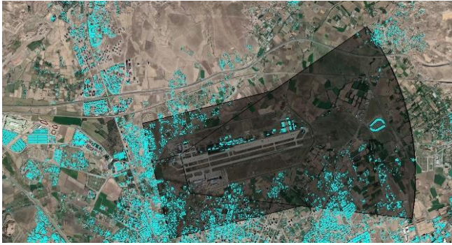
Şekil 14. LLZ25 BRA yüzeyi ve yapılar
