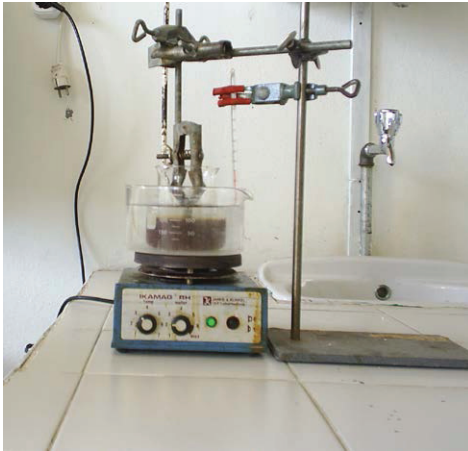
Şekil 1. Daldırma yöntemi ile kimyasal işleme deney düzeneği
