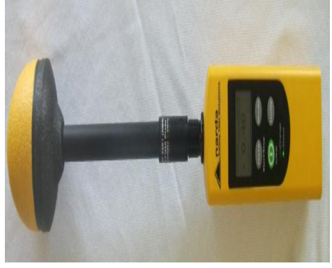
Şekil 2. Narda EF 0391 E-field 100 kHz 3 GHz Prob anteni ile NBM 520 cihazı.
