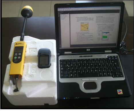
Şekil 1. DTY ile ölçüm almak üzere araca yerleştirilen düzenek
