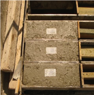
Şekil 1. Kiriş numunelerin üretimi
