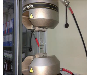
Şekil 2. Çekme test cihazına bağlanmış çentikli kompozitlevha(Çelik, 2015).
