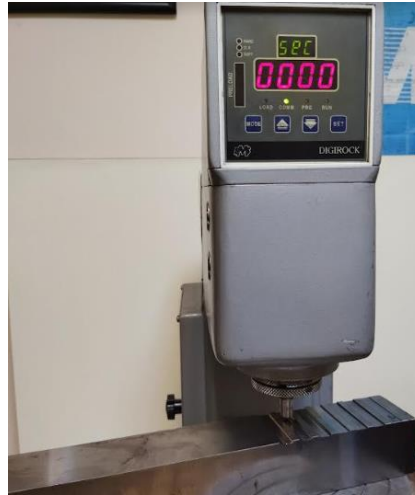
Şekil 6. Rockwell sertlik ölçüm deney ekipmanı (Rockwell hardness measurement experimental equipment)
