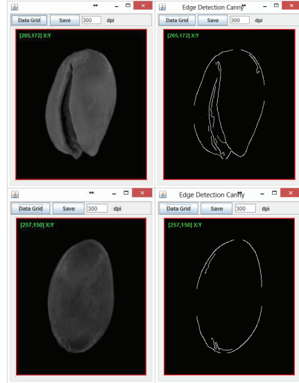
Şekil 6. Çatlak (üstte) ve çatlamamış (altta) fıstıkların, orijinal (sol) ve Canny (sağ) kenar tespit çıktıları
