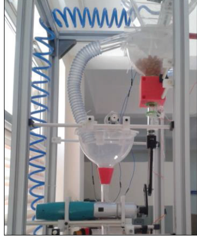
Şekil 1. Birim zamanda bir fıstık beslemeye olan tanıyan krank-biyel ve hava üfleme düzeneği
