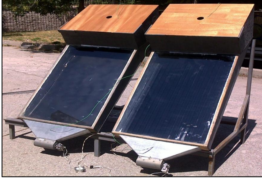
Şekil 1. Düz ve hapsedici yüzeyli kurutma fırınları
