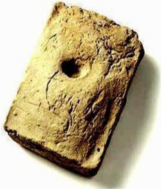
Şekil 3. Plano-konveks kerpiç bloğun görünümü [11, 13]
