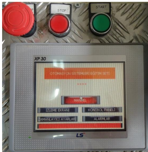
Resim 1. Monte edilmiş ve çalışır durumda Operatör paneli ve butonlar
