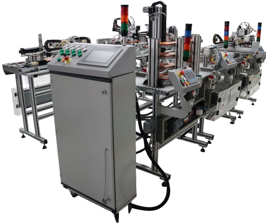
Şekil 19. Tasarlanan esnek üretim sistemi deney seti
