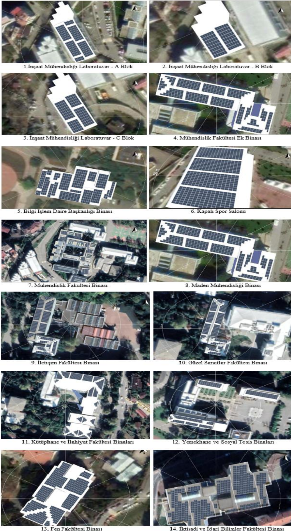
Şekil 4. Bina çatıları üzerine güneş panellerinin yerleşim planları.
