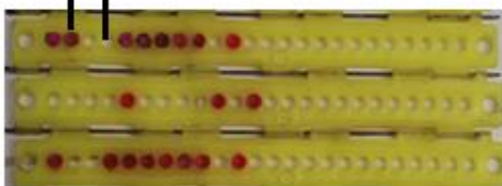
Şekil 9. Armür paletinde çerçeve hareketlerinin düzenlenmesi
