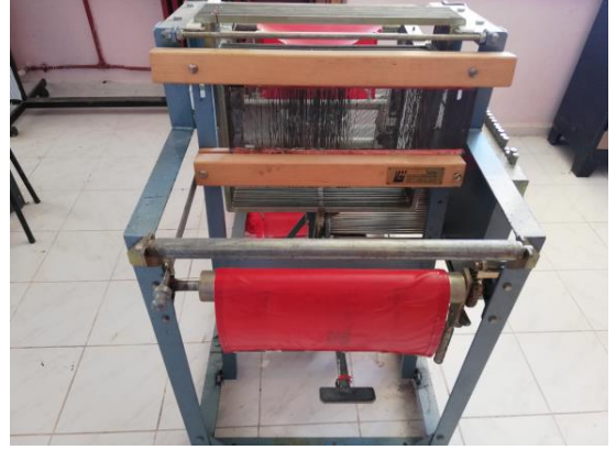
Şekil 5. Numune kumaş dokuma makinesi genel görüntüsü
