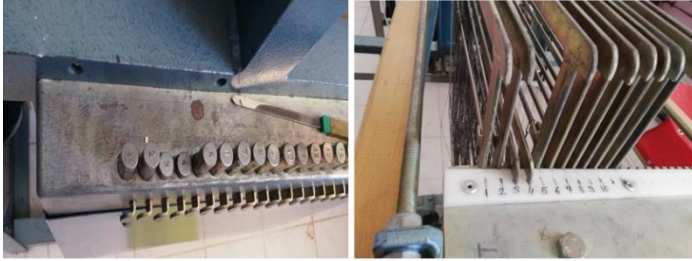
Şekil 8. Basılan düğmeler ve karşılık gelen çerçeve hareketi (basılan düğmelere bağlı çerçeveler altta)
