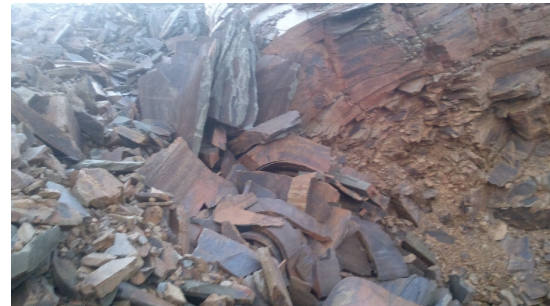
Şekil 4. Tünel giriş kesimi ileri derecede eklemlili şistler (Çakmak Fm.)
