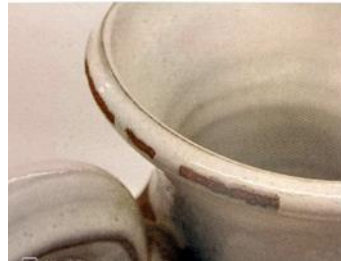
Görsel 3: Pişirme sonrası dökülmeler, 2010.
