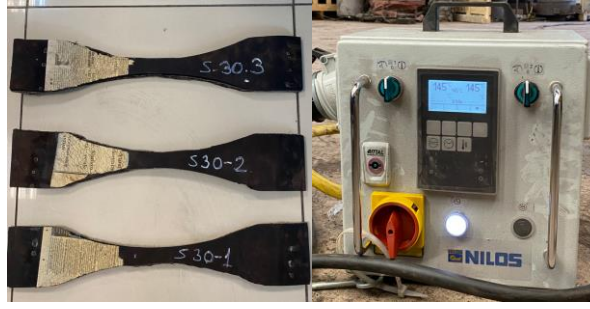
Figure 6. Specimens prepared according to the vulcanization time of 30 minutes (30 dakikalık vulkanizasyon süresine göre hazırlanan numuneler).
