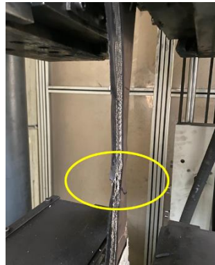
Figure 15. Breaking of specimen number S-45-2 after tensile test (S-45-2 numaralı numunenin çekme testinden sonra kırılması).
