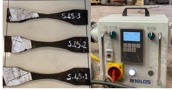
Figure 7. Specimens prepared according to the vulcanization time of 45 minutes (45 dakikalık vulkanizasyon süresine göre hazırlanan numuneler).
