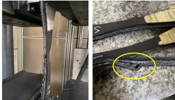
Figure 12. Breaking of specimen S-15-3 after tensile test (S-15-3 numunesinin çekme testinden sonra kırılması).
