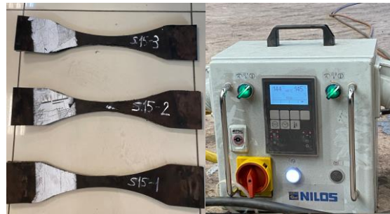
Figure 5. Specimens prepared according to the vulcanization time of 15 minutes (15 dakikalık vulkanizasyon süresine göre hazırlanan numuneler).
