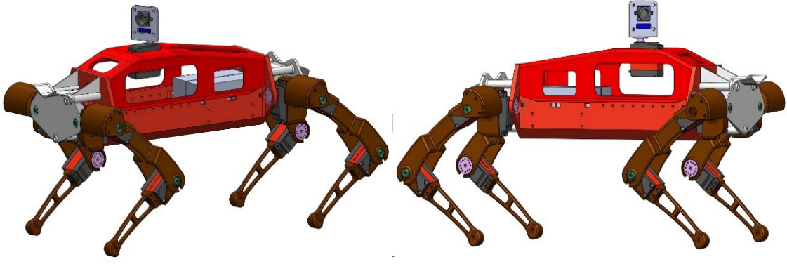
Şekil 3. Dört bacaklı keşif robotu tasarımı
