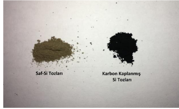
Şekil 2. Saf silisyum tozları ve karbon kaplanmış silisyum tozlarının resimleri.
