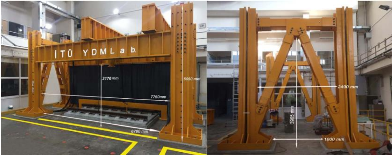
Şekil 3. Yorulma çerçevesi boyutları. Figure 3. Fatigue frame dimensions.
