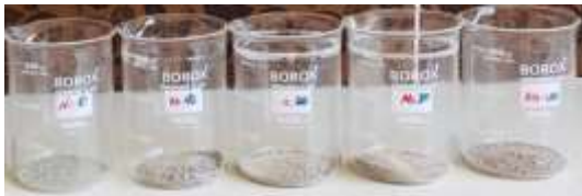
Şekil 3. TGA ve FT-IR analizleri için hazırlanan öğütülmüş numuneler
