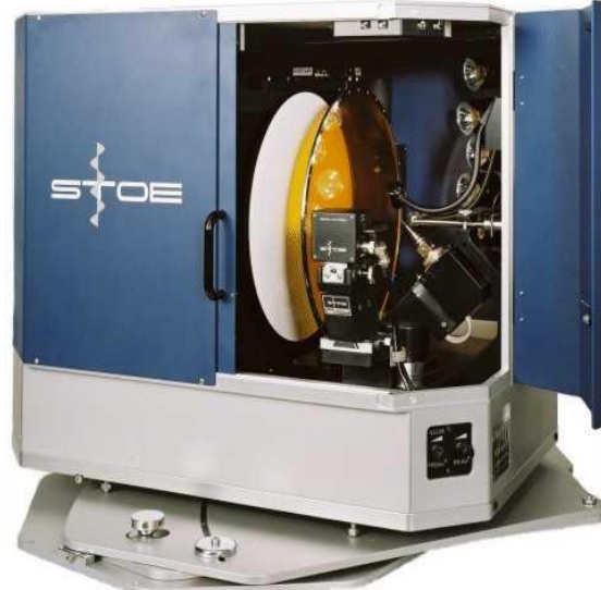
Şekil 2 Stoe IPDS-II Tek Kristal X-ışını kırınım metresi (Stoe IPDS-II Single Crystal Diffractometer)
