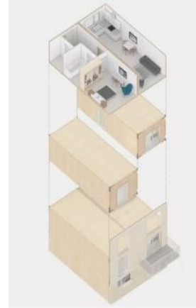
Şekil 7. Modüler Yapım Sistemi (Treehugger, 2023)
