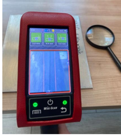
Şekil 11. Servo-Robot marka Wiki-Scan lazerli kaynak ölçüm cihazı ve merceği
