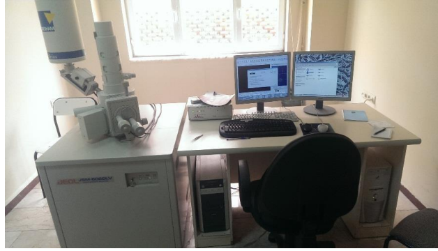
Şekil 2. Joel marka JSM-6060LV model SEM cihazı
