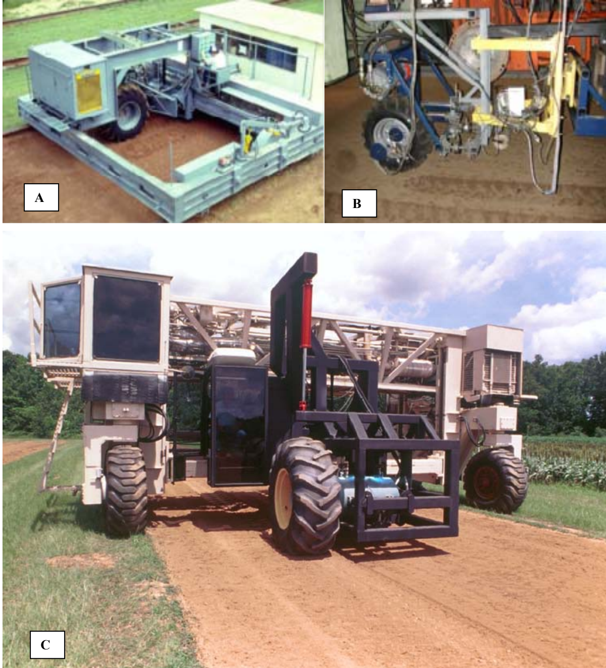
Şekil 9. Farklı zeminlerde kullanılabilen deney düzenekleri a) Burt ve ark. (1980) b) Way ve Kishimoto (2004) c) Monroe ve Burt (1989)
