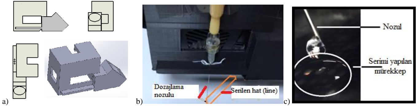
Şekil 5. a. Dozajlama ünitesi başlığının teknik detayları, b. Dozajlama ünitesi başlığının mürekkep numune serimi anındaki görüntüsü, c. Üretim sırasında dijital kameradan alınmış görüntü.
