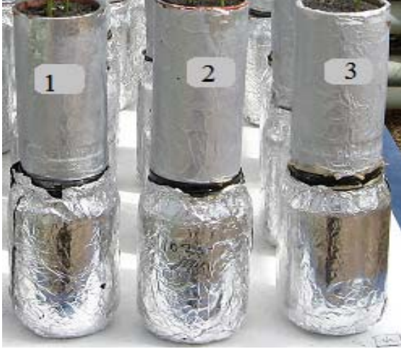
Şekil 4. Leonard'ın modifiye ettiği şişe kavanoz sistemi ve yetiştirme odasındaki şişe kavanoz denemesi
