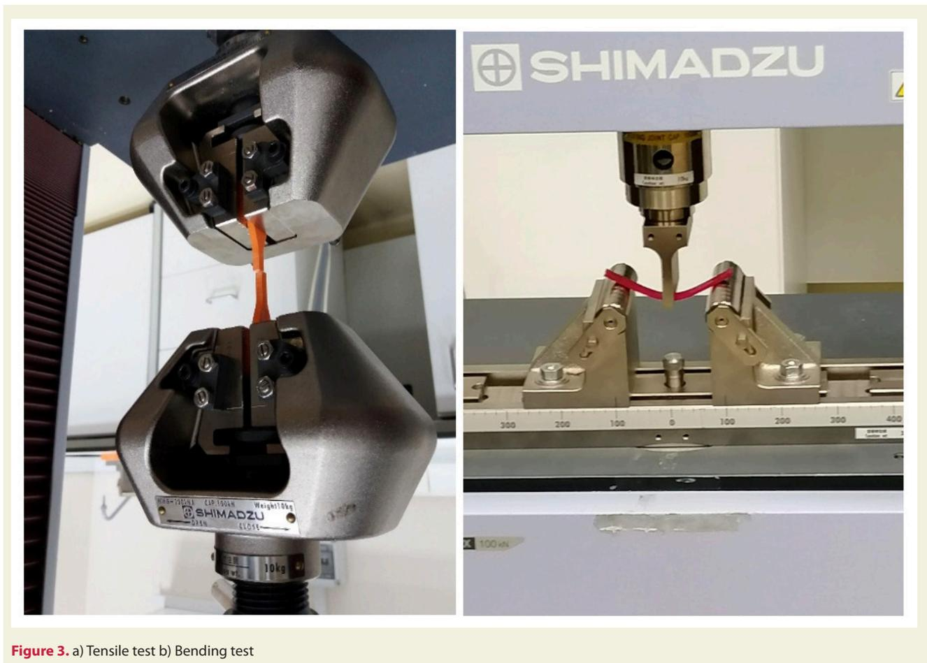
**Figure 3.** a) Tensile test b) Bending test
