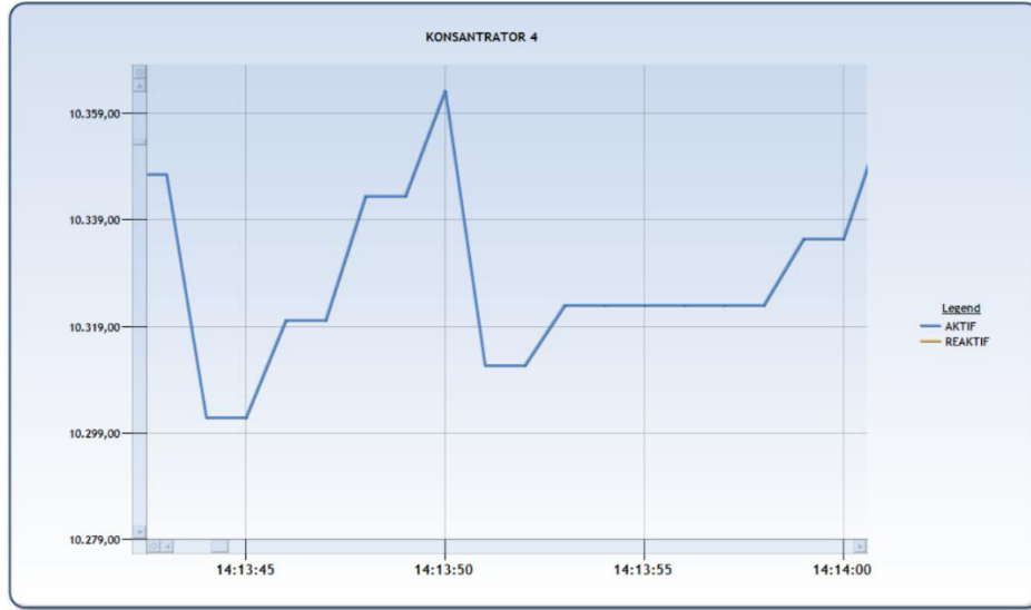
Şekil 11. Konsantratör 4 tesisi 5 saniyelik periyotta aktif güç grafiği.
