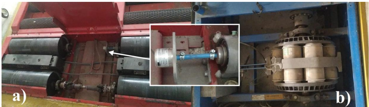
Şekil 3. a) Enkoderli ve b) elektromanyetik yük sistemli şasi dinamometreleri (Chassis dynamometers with a) encoder and b) electromagnetic load system)
