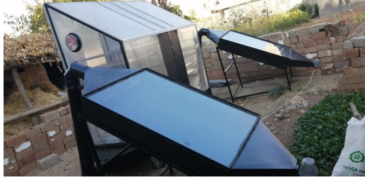
Şekil 2.1. Güneş enerjisi destekli enerji depolama sistemli tarımsal ürün kurutma sistemi (Agricultural product drying system with solar energy assisted energy storage system)
