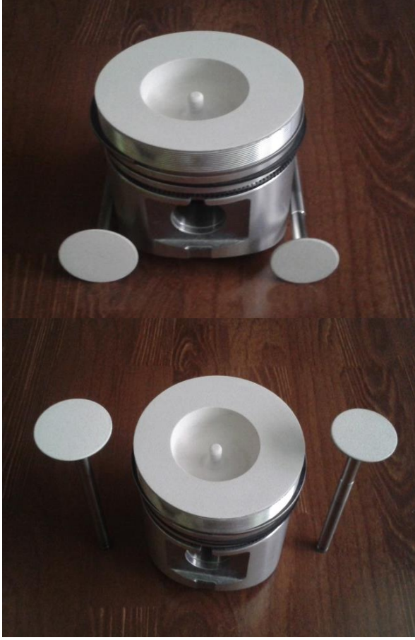
Şekil 1. Piston ve supapların alın yüzeyleri kaplandıktan sonraki görünümü
