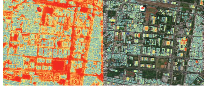
Şekil 24. DSM tabanlı solar radyasyon görüntüsü (Dewanto vd., 2020)
