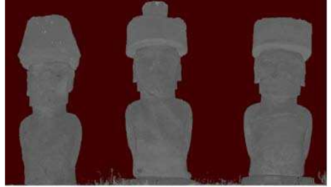
Şekil 4. Yersel lazer tarama sistemi Z+F IMAGER 5006 ile taranan yoğunluk değerlerine sahip nokta bulutunun gösterimi (Kersten vd., 2009).
