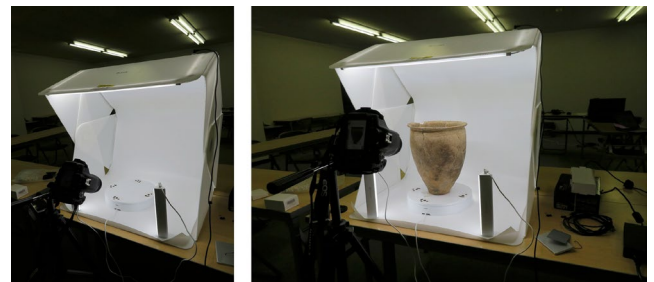
Şekil 1. Kavanozun dönel platform yardımı ile yersel fotogrametri tekniğine göre modellenmesi (Kaneda vd., 2022).
