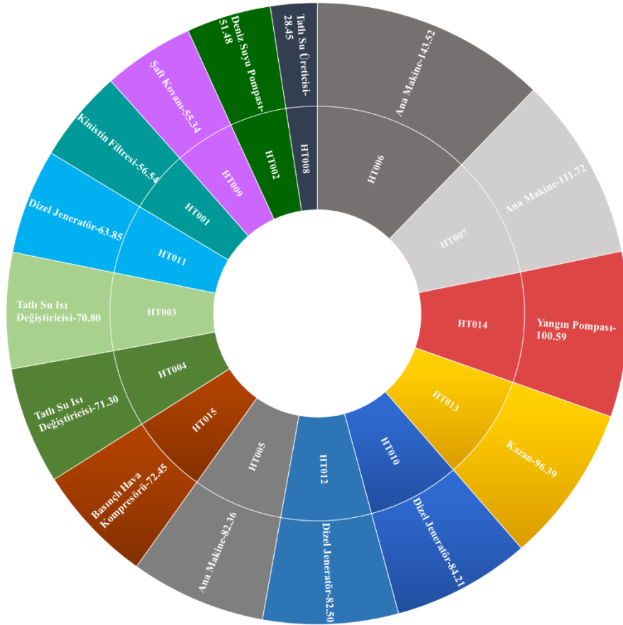
Şekil 6. Gemi kinistin sandığı tıkanıklığına ait RÖS sonuçları (Clogged sea chest RPN results)
