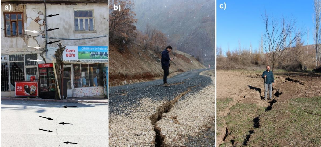
Şekil 7. 24 Ocak 2020 Sivrice-Elazığ depreminde DAFZ üzerinde görülen deformasyonlar. a) Sivrice merkezde görülen yüzey deformasyonları, b) Sivrice batısında fay zonu üzerinde yol boyunca görülen deformasyon, c) Pütürge Ormaniçi köyü güneyinde yüzeye yansıyan deformasyonlar.
